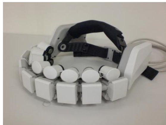
図2 測定に用いた小型 NIRS 装置
