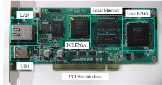
図 3 : 提案アーキテクチャ搭載 FPGA
