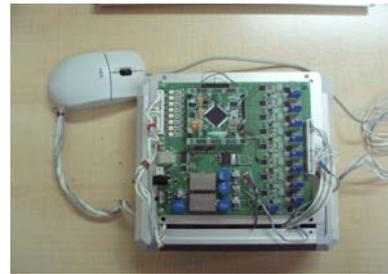
図5. 試作したインターフェースボード
