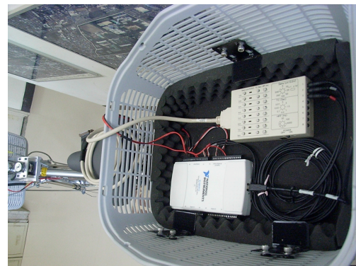
図4 A/D変換ボックスと生体アンプ
