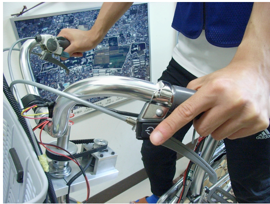
図6 ハンドルに取り付けた反応スイッチ
