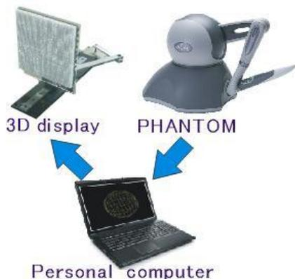
図4. 3次元電子黒板のシステム構成
