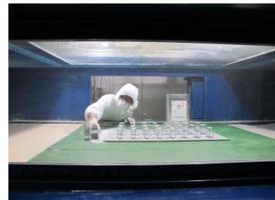
図3 模型雪による風洞実験
