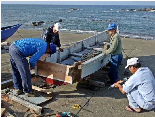
青森県階上町の磯船ホッツの修繕* 譲りうけてきた船は家大工によって補修されていく。地先の磯場にはムダマ造り（船底に割りぬき部材をもつ木造船）のホッツがよい。持ち主の上平親子も手伝って作業を急ぐ
