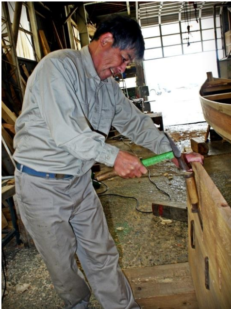
ナリウテンマの釘うち作業 氷見の造船場にて
