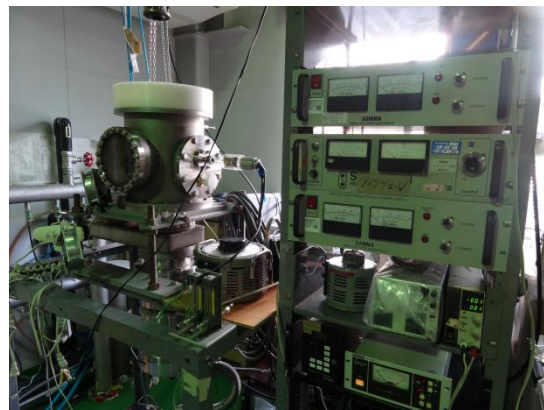
図 2. イオンビームスパッタリング装置の全体系 左が真空装置で右側にあるのが電源及びコントロールユニット
