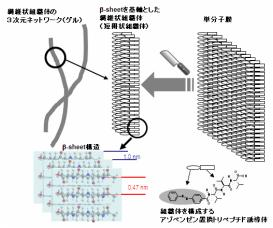
我々はこれまでに、アゾベンゼン置換オリゴペプチド誘導体を用いて、光応答性分子ゲルを創製することに成功しています(Y. Matsuzawa et al, Adv. Funct. Mater. 17, 1507-1514 (2007))。分子ゲルとは、有機低分子が非共有結合で組織化して形成された繊維状組織体が物理架橋して溶媒を取り込みゲル化する材料です。近年、その超分子的なふるまいや、形成される超構造の鋳型としての利用といった視点から着目されている
