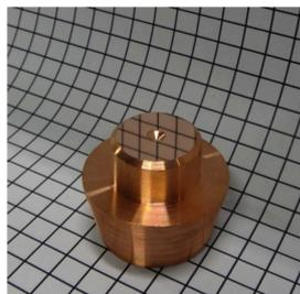
図8 開発した加工システムによる加工結果（無酸素銅の場合）
