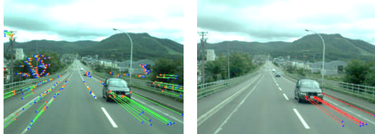
図7 SIFT 特徴量追跡 図8 対向車抽出結果
