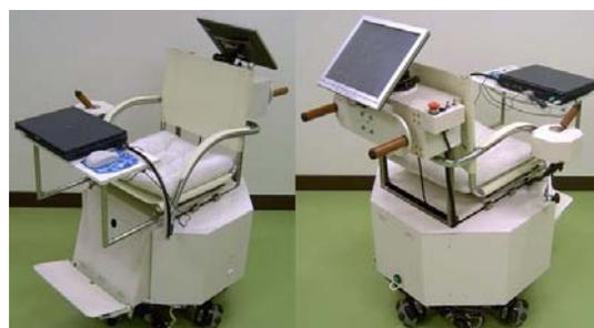
図1 従来の全方向移動車椅子
