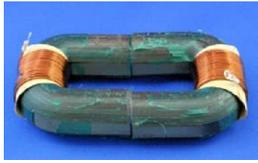
図7 試作した集電コイル
