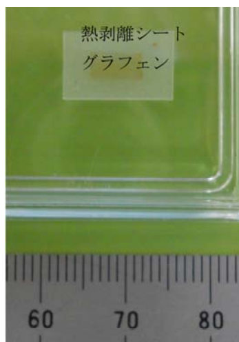
図2、剥離されたグラフェン膜の光学顕微鏡写真。
