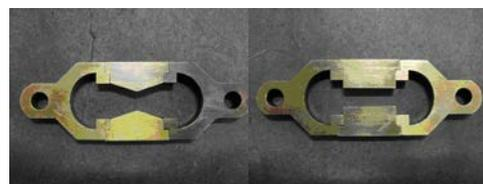
左 伸度試験用型枠、右 the force ductility test 用型枠
