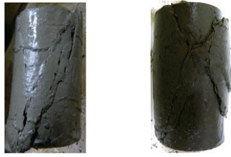
図 12 供試体破壊形状 (左:拘束圧 98kPa、右: 294kPa)
