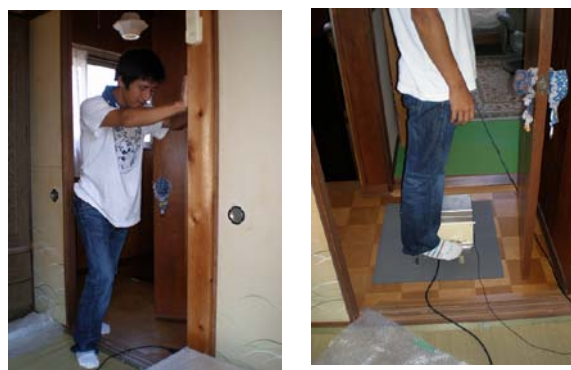
写真1 人力起振の様子 と水平起振器
