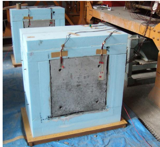
図2 壁状コンクリート試験体
