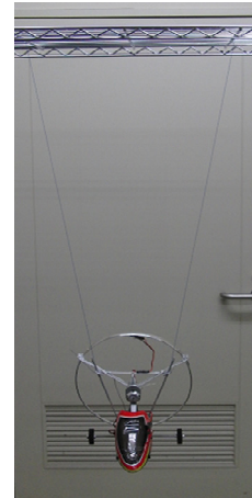
図6. 捻り振り子運動の周期の計測
