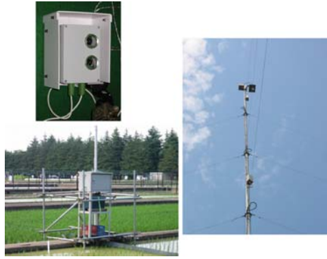
図1 可視・近赤外2バンドデジタル反射係数観測用カメラシステム
