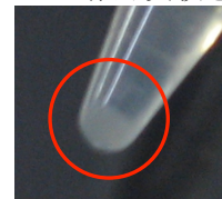
図 8. 0.2% SDS と反応した沈殿物
