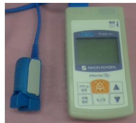
図4 日本光電社製心拍数記録装置(P225F)。人差し指にパルスセンサーをセットし脈拍数の変化を時系列的に記録することができる。赤外線は 660\mu\text{m} と 940\mu\text{m} で計測された。
