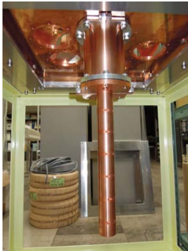
図5 モデル共振空洞の加速電極とライナー (上図)、外筒とショート板 (下図)
