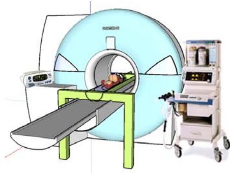
図1. 霊長類動物脳MRI撮像システム。3T MRI装置、RF送受信コイル、長時間麻酔下撮影用呼吸管理・モニター装置、除振固定台、高解像度撮像シーケンス等から成る。
