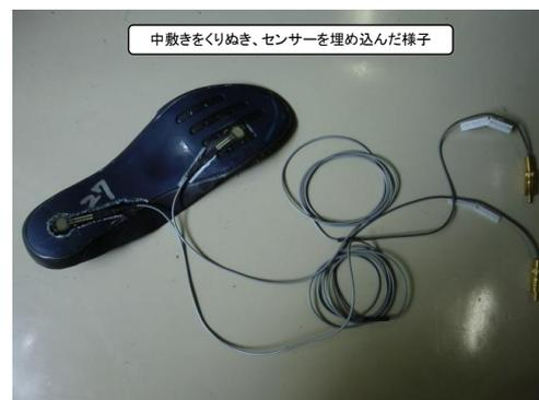
前頁の写真はフットスイッチをシューズの中敷きに貼付したときの様子である。写真の中敷きをシューズに装着し、中継器に接続した様子が下の写真である。
