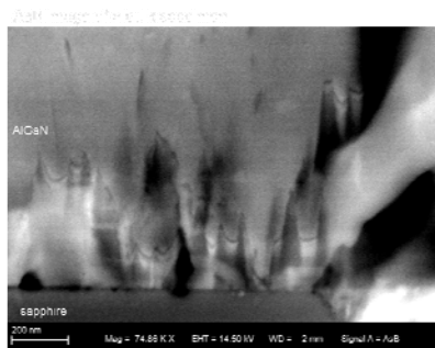
図 3 AlGaIn 試料の SEM-AsB 像 (拡大)
