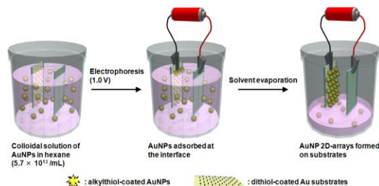
図4 金ナノ粒子2次元配列作製法。金ナノ粒子へのアルカンチオール修飾による自己組織化手法に、溶媒蒸発と電気泳動を組み合わせたもの。
