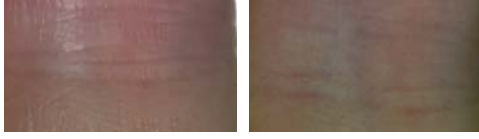
図 4 試作機で撮影した人皮膚（指関節部位腹側）の写真。左：白色光反射照明、右：偏光反射照明・クロスニコル法にて撮影。
