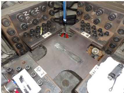
図 1 二軸載荷疲労試験の様子
