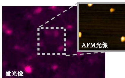
図 5 高速 AFM/蛍光顕微鏡による \phi 40nm の蛍光性ビーズの同時観察像. AFM 像の走査範囲は 800 nm × 800 nm.
