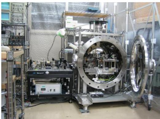
図：開発した振れ振り子装置
