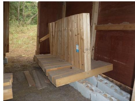
写真 2 シロア리를寄せた小屋内に試験体を設置して食害が進むのを待つ
