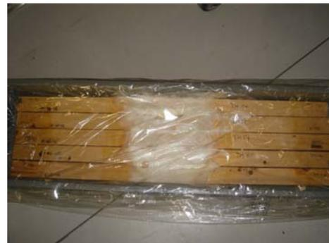
写真 3 中央部だけの腐朽促進試験の様子
