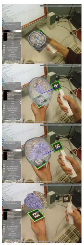
拡張現実を用いたインタラクティブなボリューム セグメンテーションと可視化.シードポイントの 配置後,インタラクティブな領域抽出の様子を示 している.ここでは紫色で示された右脳の領域を 抽出している.
