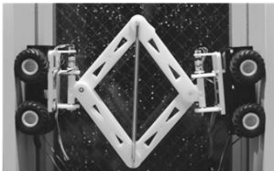
図5 開発した壁面間移動ロボット
