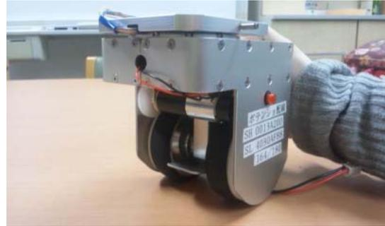
アクティブキャストは、PC より無線通信により制御信号を受信するが、この無線通信に遅延が発生すると、その遅延が制御指令値に対する誤差となる。リモコンを用いた制御であれば、人間による修正で誤差を低減できるが、自動システムの場合はこの遅延による誤差の蓄積が、位置決め精度に大きく影響を与える可能性がある。しかしながら、キャストという特性上、時間遅れの影響以外にすべりの影響も無視することはできない。
