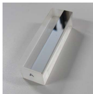
図 2 作製した集光ミラー。ガラス基板のエッジ部分に楕円形状を作製した。
