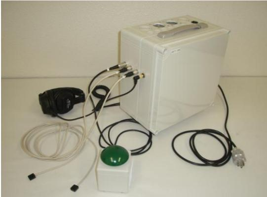
図4 構築したバイオフィードバック装置
