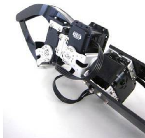
図1 義肢エージェント第1試作機
