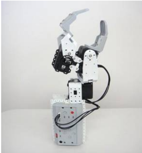
図4 義肢エージェント第2試作機
