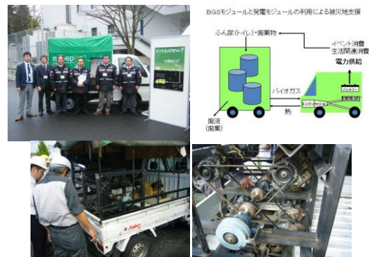
図-1 自走式発電車輛の概要
