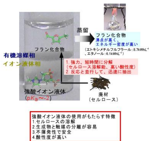
図1 強酸イオン液体を用いた二相系反応によるセルロースのエネルギー物質変換
