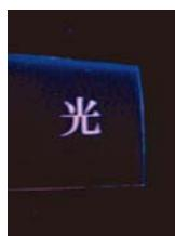
図3. 高分子薄膜中に作成された金クラスターの写真。フォトマスクを用いて高分子中に金クラスターで“光”的文字を書いてある。
