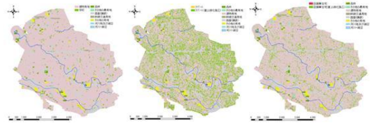
図-6 杉並区における屋上緑化施工の有無による緑量の違い(左から, 学校, アパート, 店舗兼住宅の屋上に緑化システムを施工した場合)
