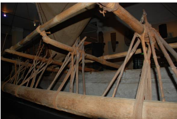
写真 4・5 ニュージーランド・オークランド博物館所蔵のソロモン諸島ティコピア島のアウトリガー・カヌーの全体の様子（上）と、アウトリガーのペグ（腕木と浮木の接合部）の拡大写真（下）。ペグの部分はハイビスカス製の縄でたくみに結合されていることがわかる。このようなカヌーの素材となる有用植物の重要性について、これまで考古学のなかで注目されることは少なかった。
