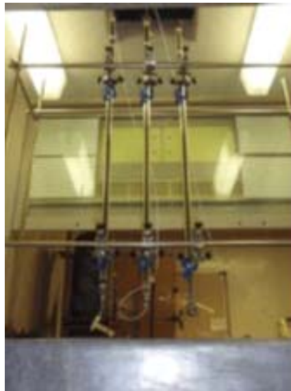
図 1：泳動パラメータの最適化のために使用する泳動システム。 1\text{m} のガラスカラム 3 本を、テフロンチューブでつなぎ、泳動距離 3\text{m} のテストが行えるようになっている。
