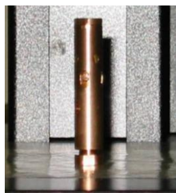
図 1. SQUID 磁束計用の超小型 DAC
