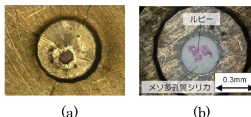
図 5. 超小型 DAC を用いた実験でのガスケットの写真
