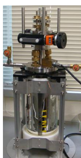
図 2. 超小型 DAC 用の酸素封入装置
