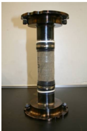
図 1．三軸伸張試験に使用した砂岩試料．上下はエンドピース．
