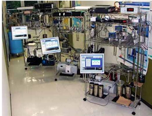
構築した導入システムと既存のマイクロインレットシステムから 100 % CO<sub>2</sub> ガスを複数回測定した場合の外部精度は <sup>13</sup>C・<sup>18</sup>O とともに 0.01‰ 前後であり、内部精度とほぼ同等の外部精度を引き出せることがわかった。また、開発した小型多連式ガス精製装置でガス化した標準炭酸塩 NBS19 (約 70 μg) の安定同位体組成は外部精度で <sup>13</sup>C・<sup>18</sup>O とともに 0.1‰ 以下であり、20～2000 μg 相当の炭酸塩を同一手順で分析できる。また、ガスの挙動を可視化するなど、全ての分析過程での透明性を確保しているため、高品質のデータセットを得ることができるようになった。
