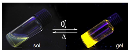
図 5. (±)- anti-1a のシクロヘキサン溶液の超音波照射によりゲル化と発光強度増大現象
