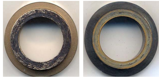
(a) 400°C (b) 700°C 図5 摩擦試験後の摩擦痕の様子
