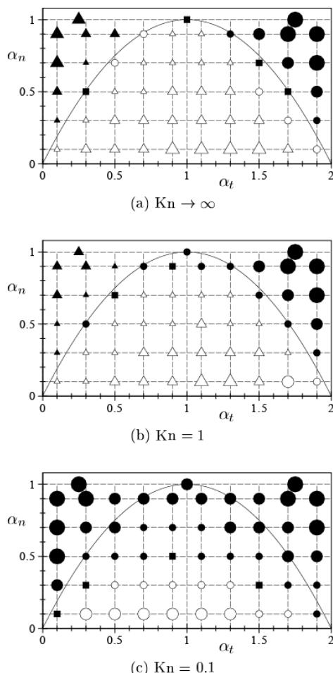
図 2 : 流れ場のパターンの変化。図中の実線は、放物線  $\alpha_n = \alpha_t(2 - \alpha_t)$  である。
