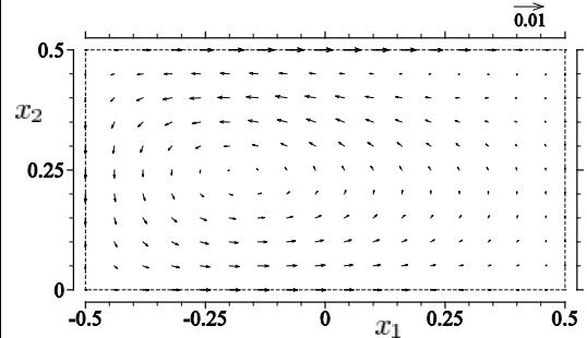
図1：自由分子気体( $\text{Kn} \rightarrow \infty$ )で、 $\alpha_t = \alpha_n = 0.5$ における流れ場。
